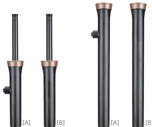
[A] PROS-06-SI-PRS30* [B] PROS-06-PRS30* Altura retraída: 22,5 cm Altura de elevação: 15 cm Diâmetro exposto: 5,7 cm Tamanho da entrada: ½"
